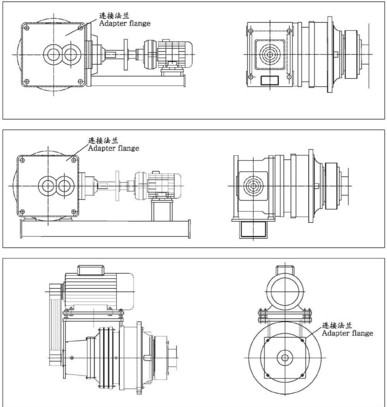
在不能采用电机安装法兰的场合，我们使用一个连接法兰与电机支架固定。
