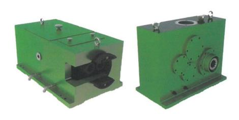
SZ系列锥形双螺杆挤出机齿轮箱是与锥形双螺杆塑料挤出机配套的专用机械传动装置,由传动箱与分配箱两部分组成。主电机动力经传动箱减速增扭后。输出至分配箱,再通过一对1:1传动比的小锥角螺旋齿轮驱动双出轴(两轴夹角与两螺杆夹角相同),带动螺杆以异向外旋的方式运转。
